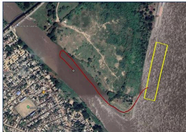
Ilustración 7. Esquema de metodología de dragado desembocadura Canal del Dique.
